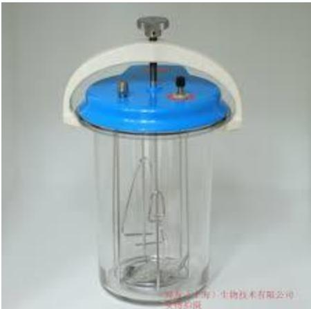
جرة الحضانة اللاهوائي Anaerobic jar
